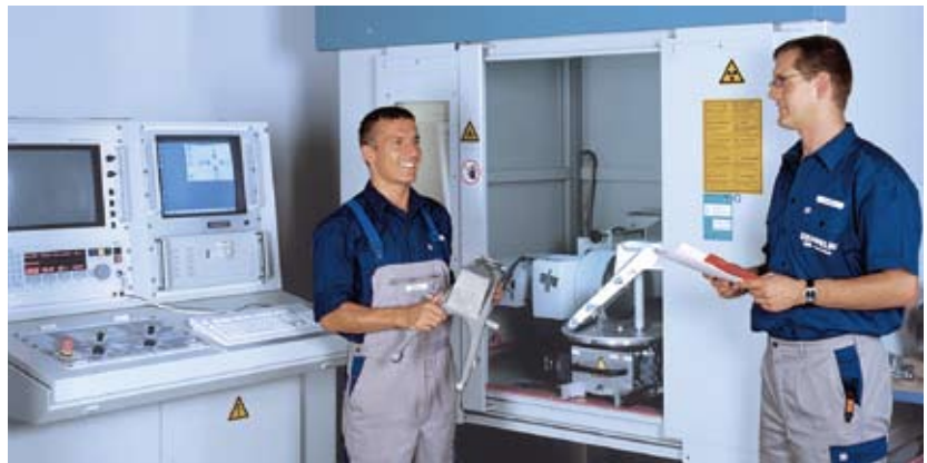
Röntgen mit der 420 kV-Hochleistungs-Röhre und Rundstrahlröhre (Bild ganz unten).
