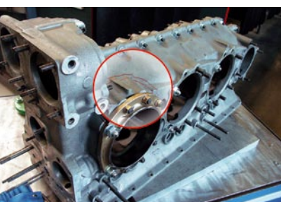
Reparaturschweißung an einem Motorengehäuse – ohne Vorwärmen geschweißt, Risse ausgearbeitet und komplett geschweißt. Vorteil: keine messbaren Abweichungen an Passungen oder mechanisch bearbeiteten Flächen nach dem Schweißen.
